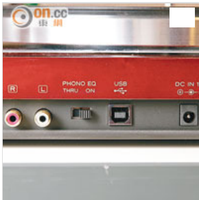
可透過USB將黑膠碟音樂轉為數碼格式，再經USB傳送至電腦儲存。
